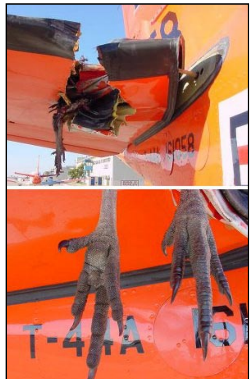
Результат столкновения грифа с самолётом. Фото предоставлено М. Грабовским
