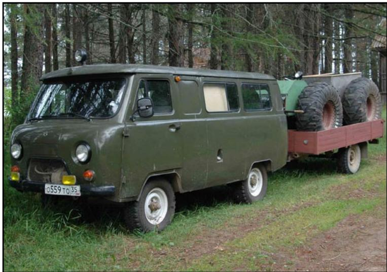
Экспедиционный автомобиль УАЗ, приспособленный для перевозки вездехода-болотохода.
