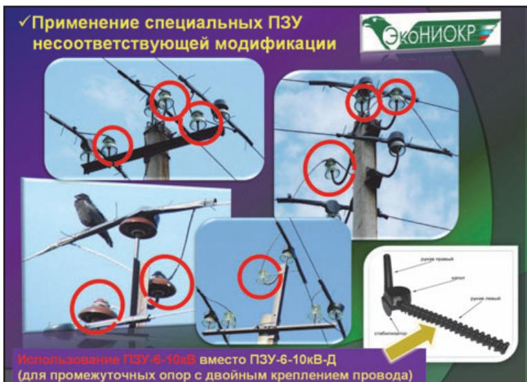
Рис. 10. Применение ПЗУ-6-10кВ вместо ПЗУБ-10кВ-Д.
