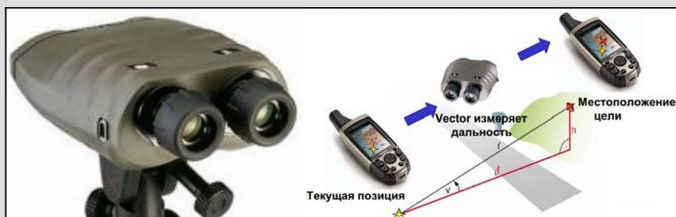
ВЕКТОР 21 – самое распространённое устройство наблюдения из предлагаемых компанией Vectronix. Это биноклярный лазерный дальномер с семикратным увеличением и полем обзора 6,75°, имеет цифровой компас и способен измерять расстояния до 12 км.
